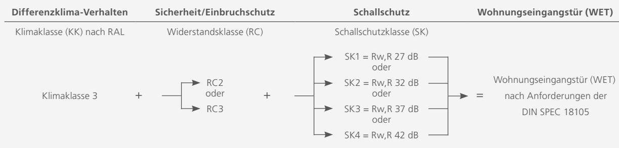
Geprüfter Schalldämmwert ( $R_{w,P}$ ) abzüglich Vorhaltemaß für Türen nach DIN 4109 (5 dB) ergibt den errechneten Schalldämmwert ( $R_{w,R}$ ).
